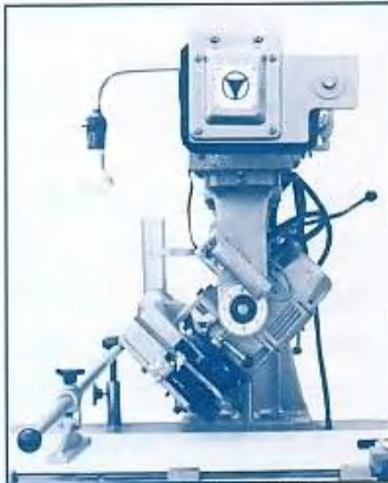
▲モーターヘッドを45°傾斜して .....留切加工
