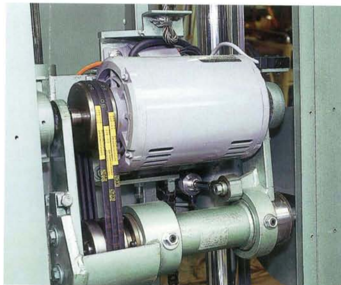
精度の微調整のできる心臓 鋸軸にはアンギュラベアリング使用 パネルソー全機種装置
