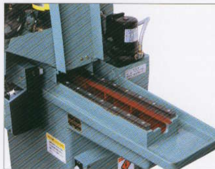
リニアガイドレール：長時間に渡って高精度を維持。メンテナンスも簡単です。
